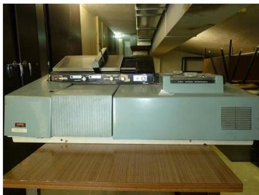
Figura 8: espectrofotómetro UNICAM SP 800 adquirido no início da década de 70
