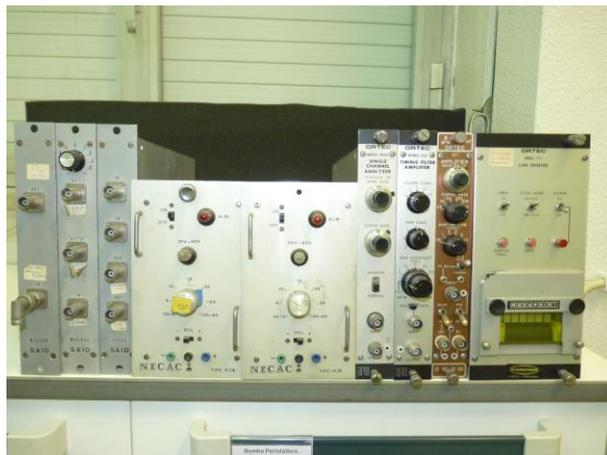
Figura 5: Unidades que constituíram o sistema de medida de rendimentos de radioluminescência; as cinco unidades da esquerda foram construídas nas oficinas do complexo e correspondiam a circuitos electrónicos que, pelas suas características, não eram na altura comercializadas.
