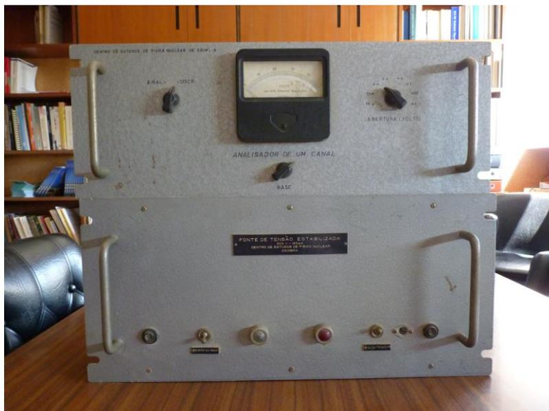
Figura 3: Analisador monocanal construído em 1961 no Laboratório de Física da Universidade de Coimbra
