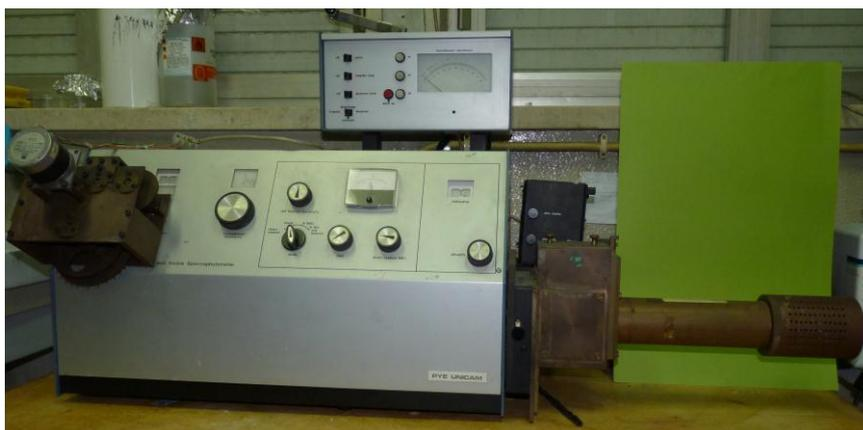
Figura 7: Comparador Quântico montado, em 1971, acoplado a um aparelho comercial unidades em latão construídas nas oficinas mecânicas dos SAID e de electrónica desenvolvidas para esse efeito nas oficinas de electrónica.
